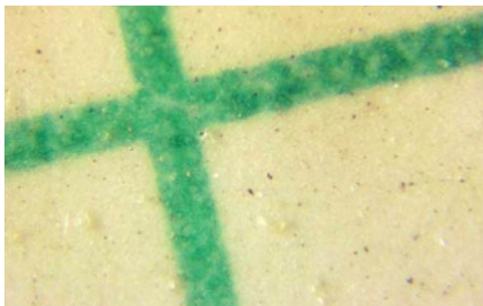
Prueba de parche tomada in situ en la evaluación ISOCLEAN Con una magnificación de 100X
