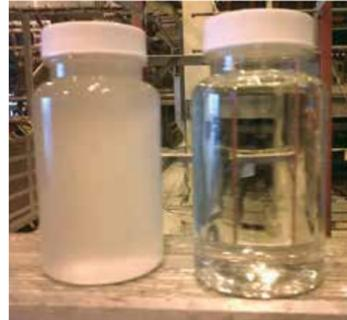
La muestra que se observa a la izquierda es aceite hidráulico real con altos niveles de humedad y contaminación de partículas según el Código de Limpieza ISO 22/21/20. En el recipiente de la derecha se ve la muestra después de haber retirado los contaminantes conforme al nuevo Código de Limpieza ISO 18/16/13.
