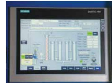
Monitoreo de filtración (arriba) y sistema de filtración (abajo a la izquierda)
