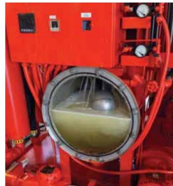
Deshidratadora al vacío utilizada para remover la contaminación de agua.
