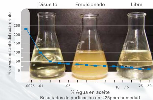
El mayor porcentaje de agua en un lubricante acelera el desgaste de los rodamientos. En los vasos de precipitación que se observan arriba, la concentración de agua aumenta de derecho a izquierda, y reduce la vida del rodamiento.
