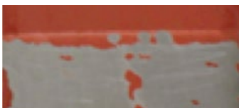
Panel de pintura expuesto al lubricante convencional para engranajes durante un período prolongado.
