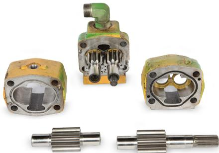
Los engranajes de la bomba hidráulica y la carcasa se observaron en muy buena condiciones, no presentaban ningún tipo de desgaste, ni residuos de laca o picaduras, incluso después de 10,000 horas de funcionamiento.
